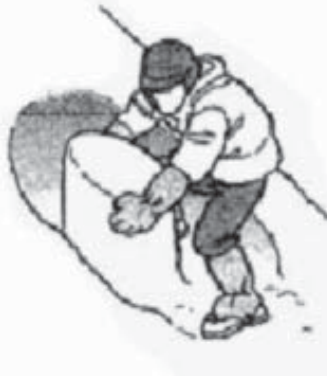
② 高さが20～30cmほどの円柱を掘り出し、上部を両手で抱えて引く
