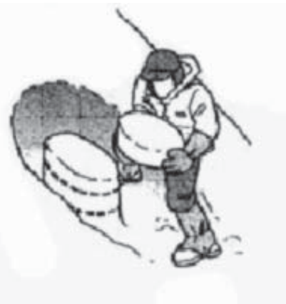
③ 軽く引くだけで、円盤状にはがれたら弱層あり。①②の作業を繰り返して、深さ70cmまでテストする
