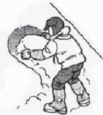
① 安全な斜面を選び、雪面に直径30cmほどの円を描く
